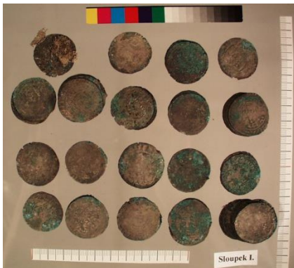
Koroze stříbrných mincí, Středočeské muzeum v Roztokách u Prahy, D. Perlík
