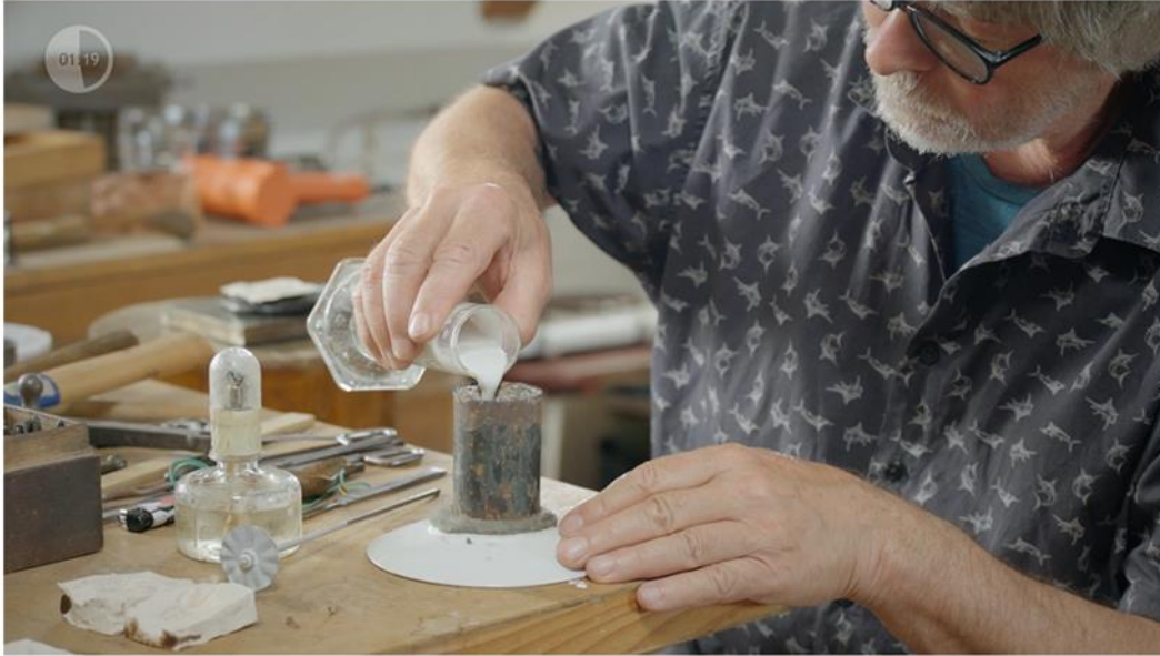
Odlévání na ztracený vosk v praku – A. Šumbera: restaurování Relikviáře sv. Maura; https://www.zlate-remeslo.cz/index.php/rekonstrukce-sub/ostatni/2-uncategorised/34-ztraceny-vosk
