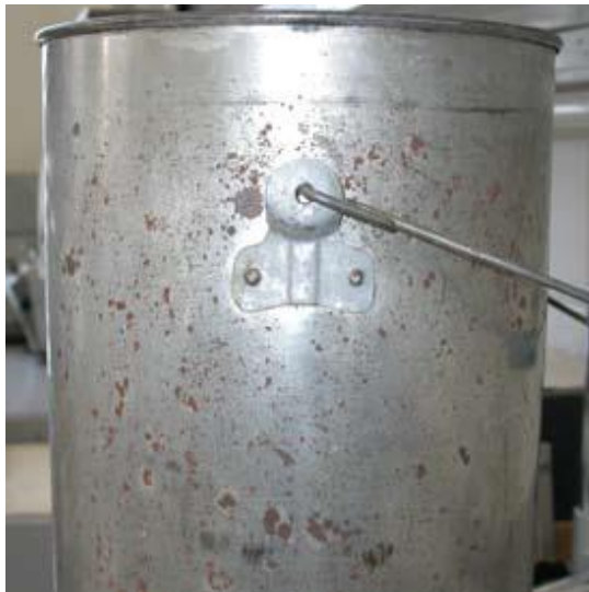
Koroze železa na cínované nádobě a kování
