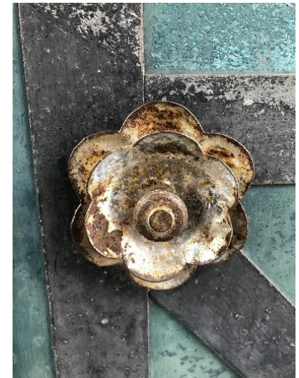
Koroze železa na cínované nádobě a kování
