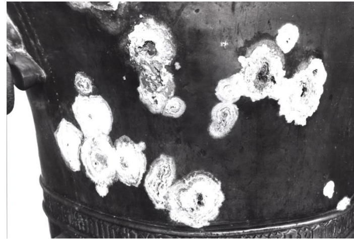
Detail cínového moru, křtitelnice, foto Eisler
