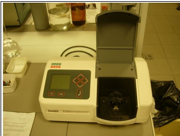
OBR. 1: Spektrofotometr Jenway 6300. Měřicí komora se 4 pozicemi pro kyvety.
