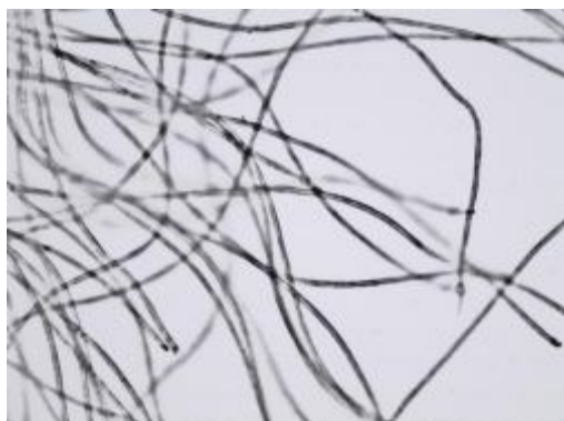
Obr. 13. Krok č.1 nenarušené akrylové vlákno
