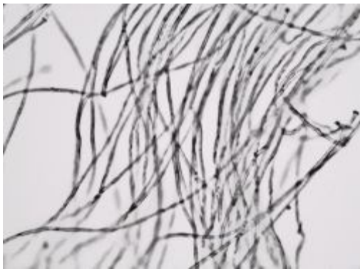
Obr. 17. Krok č.1 nenarušené PES vlákno
