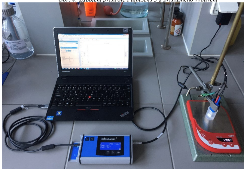
Obr. 5: Připojení přístroje PalmSens 3 k počítači
