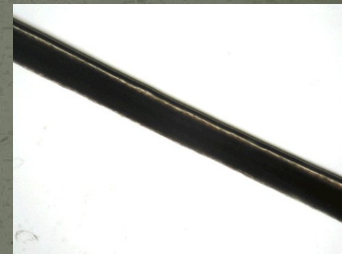
poškození způsobená konc. NaOH
