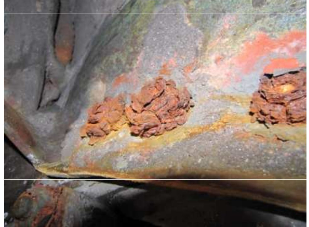
Zkorodované železné šrouby na bronzovém pomníku Jana Žižky - http://www.houska.cz/srouby-na-spojich
