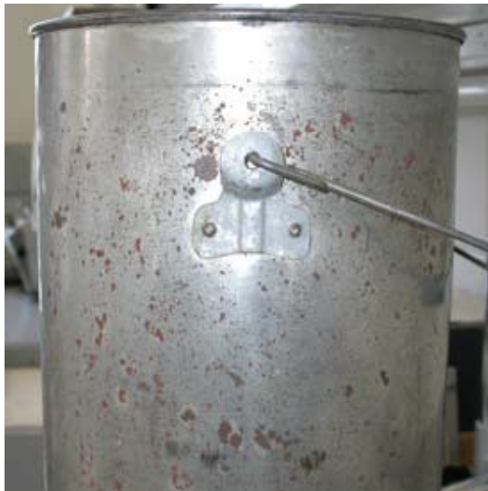
Koroze železa na cínované nádobě a kování
