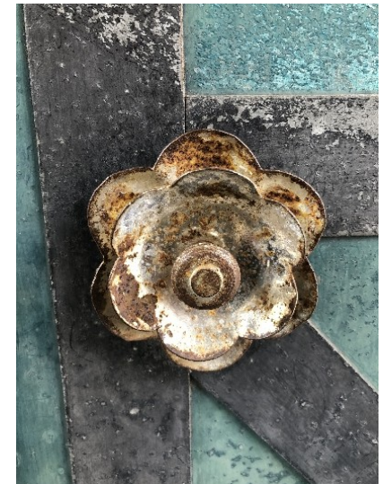
Koroze železa na cínované nádobě a kování
