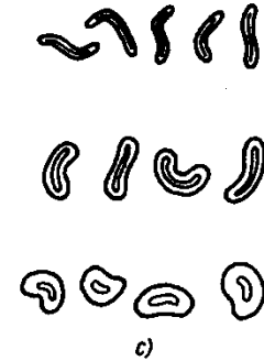
Obr. 9. Bavlna a – vlákno bavlny, b – řez vláknem, c – tvary vláken v průřezu
