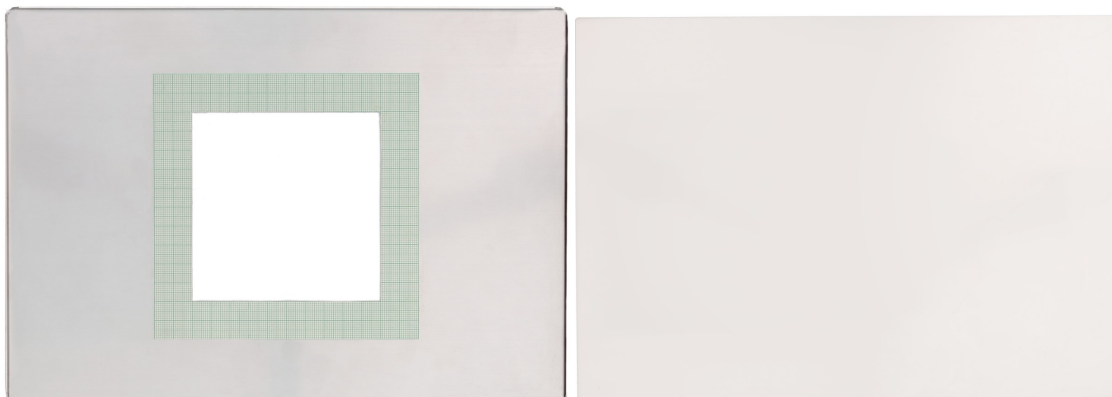
Obr. 6 Kovový rámeček s vnitřním otvorem 10 x 10 cm včetně milimetrového měřítka (bez štítku s evidenčním číslem) a podložní kovová deska
