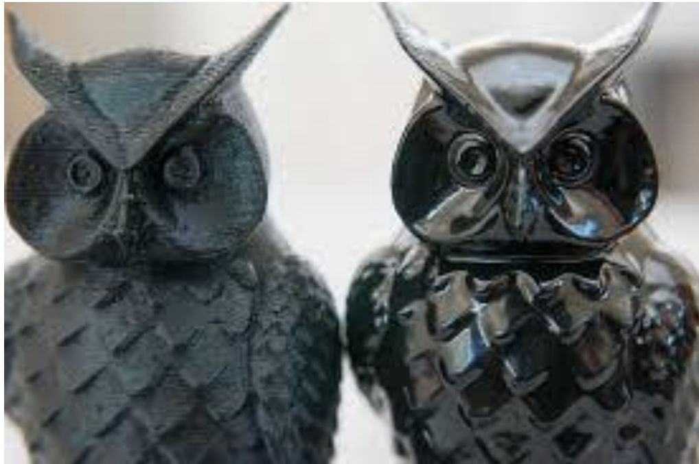
Obr. 11: Postprocessing tisku ABS s využitím acetonu
