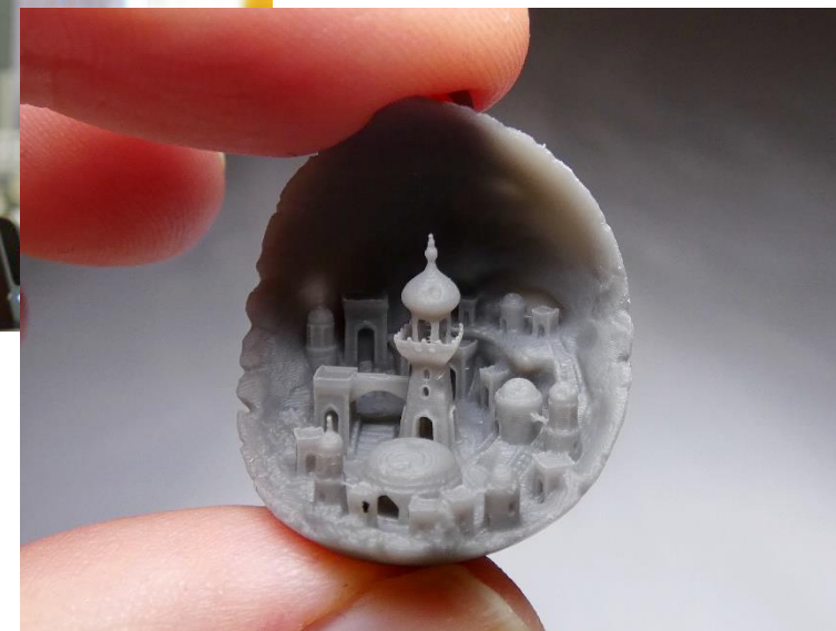
Obr. 5: Ukázka výtisku na SLA tiskárně 2
