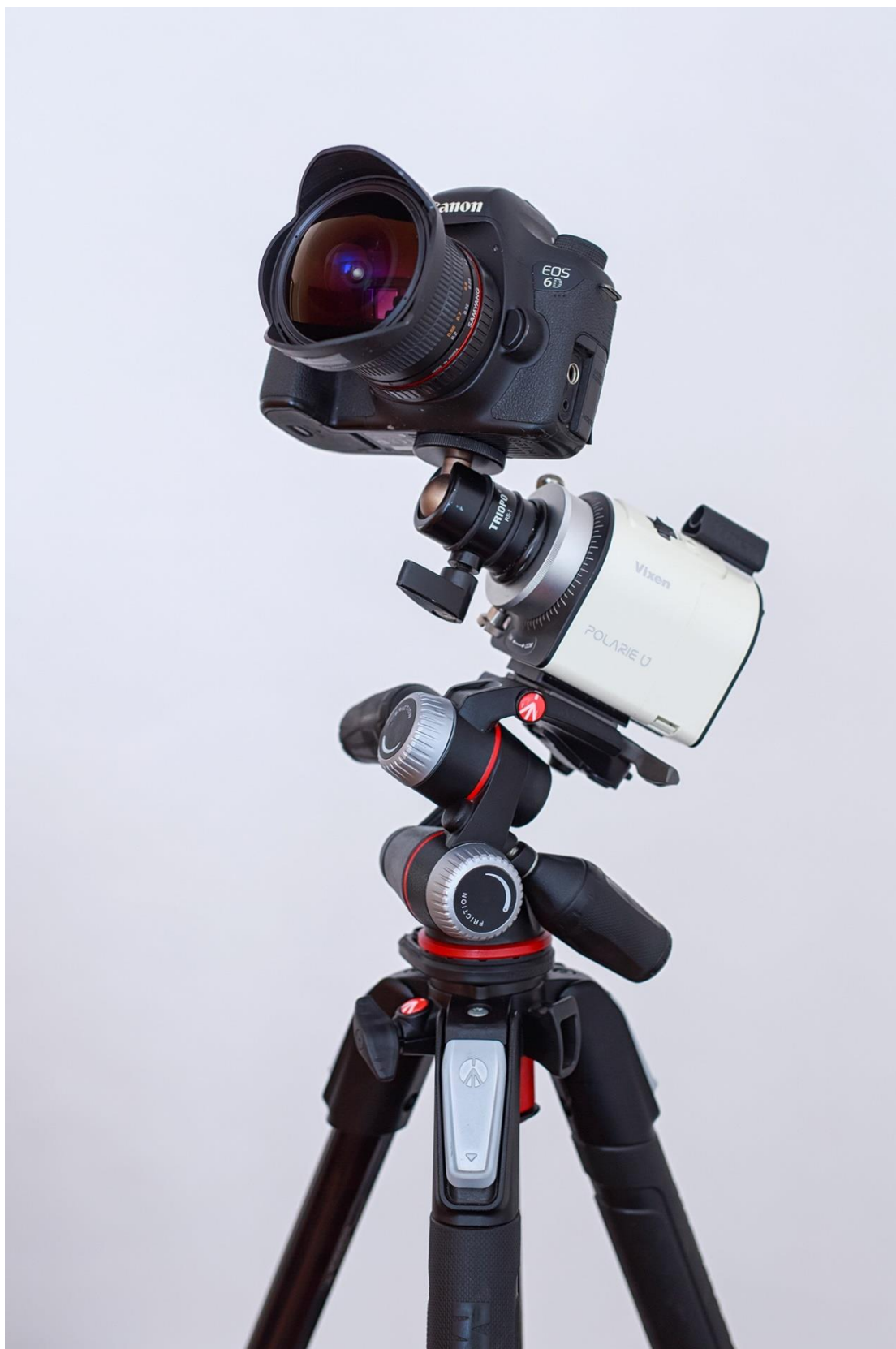
Obrázek 5.2: Sestava aparátu se světelným objektivem umístěným na malé přenosné montáži, která je upevněna ke kulové hlavě na stativu. Přenosné montáže mají nosnost až několik kilogramů a jsou výborným řešením pro cestování za pointovanou krajinářskou astrofotografií. Foto: Petr Horálek.
