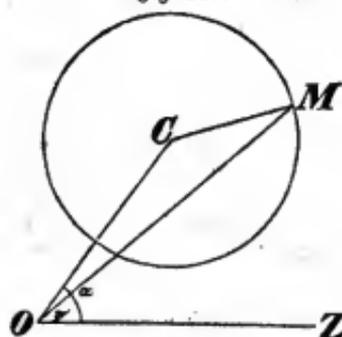
2. Liegt der Pol O (Fig. 307) nicht im Mittelpunkte C des Kreises, so sei  $OC = \rho$  der Leitstrahl des Mittelpunktes, und  $COZ = \alpha$  der Winkel, den dieser Leitstrahl mit der Polaraxe OZ bildet. Ist nun M irgend ein Punkt der Kreislinie, also  $r = OM$  sein Leitstrahl und  $v = MOZ$  der Winkel desselben mit der Polaraxe, so erhält man, wenn der Halbmesser  $CM = a$  gesetzt wird, aus dem Dreiecke CMO
