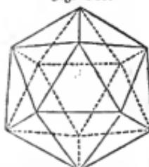
Das Icosaëder (Fig. 220) wird von zwanzig gleichseitigen Dreiecken begrenzt, von denen je fünf einen Körperwinkel bilden; es hat 12 Ecken und 30 Kanten.
