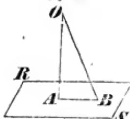
Es sei  $OA \perp RS$  (Fig. 194), so kann aus dem Punkte  $O$  nicht noch eine zweite Gerade, z. B.  $OB$ , auf die Ebene  $RS$  senkrecht geführt werden. Denkt man sich nämlich durch den Winkel  $AOB$  eine Ebene gelegt, welche die Ebene  $RS$  in der Geraden Linie  $AB$  schneidet, so ist in dem Dreiecke  $AOB$  nach der Voraussetzung der Winkel  $A$  ein rechter, daher muß  $B \hat{=} \text{Fig}$  sein, und es kann daher  $OB$  auf die Ebene  $RS$  nicht senkrecht stehen.
