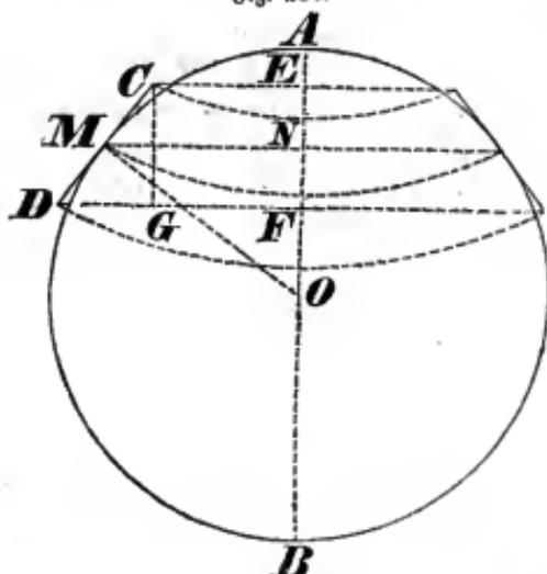
$MN \cdot CD = MO \cdot CG$ . Substituiert man diesen Werth in dem früher für M erhaltenen Ausdrucke, so hat man  $M = 2\pi \cdot MO \cdot CG$ . Da nun  $2\pi \cdot MO$  die Peripherie eines größten Kreises der Kugel, und  $CG$  die Höhe des Kegelschnittes vorstellt, so gilt der Satz:
