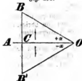
Ist der Winkel  $AOB = AOB'$ , setzt man  $AOB = \alpha$ , und denkt sich die Winkel durch die Drehung von AO aus entstanden, so muß  $AOB' = -\alpha$  angenommen werden. Macht man nun  $OB = OB' = 1$ , und zieht von B und B' auf AO Senkrechte, so müssen die dadurch entstehenden Dreiecke kongruent sein, und daher jene beiden Senkrechten in demselben Punkte C zusammentreffen. Da nun  $BC = \sin \alpha$ ,  $B'C = -\sin(-\alpha)$ , und  $OC = \cos \alpha = \cos(-\alpha)$  ist, so folgt
