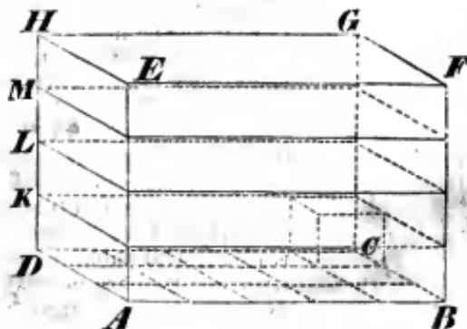
Weil die Grundfläche ABCD  $5 \times 3 = 15 \square'$  enthält, so läßt sich darauf ein Kubiffuß 15mal auftragen; das Parallelepiped enthält also bis zu einer Höhe von 1' eine Schichte von 15 Kubiffuß; zu der Höhe KL gehört eine neue Schichte von 15 Kubiffuß, eben so zu der Höhe LM, NH; das ganze Parallelepiped hat daher  $15 \times 4 = 5 \times 3 \times 4 = 60$  Kubiffuß.
