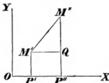
Bezeichnen wir die Koordinaten des Punktes  $M'$  (Fig. 276) durch  $x', y'$ , und jene des Punktes  $M''$  durch  $x'', y''$ , so ist  $x' = OP', y' = M'P'$ ;  $x'' = OP'', y'' = M''P''$ . Sieht man nun  $M'Q \perp M''P''$ , so ist in dem rechtwinkligen Dreieck  $M'QM''$
