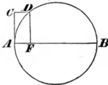
Beschreibt man daher (Fig. 270) über dem Durchmesser  $AB = a$  einen Kreis; errichtet auf  $AB$  die Senkrechte  $AC = b$ , zieht  $CD \parallel AB$  und  $DF \perp AB$ ; so sind die Abschnitte  $AF$  und  $BF$  die Werte von  $x$ . Denn sowohl  $AF$  als  $BF$ , in die Gleichung  $x(a - x) = b^2$  statt  $x$  substituiert, leistet dieser Genüge, indem man in beiden Fällen auf das Resultat  $AF \cdot BF = DF^2$  geführt wird, dessen Richtigkeit in der Lehre vom Kreise bewiesen wurde.
