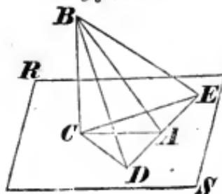
Es sei (Fig. 200)  $AC$  die Projektion der schiefen Geraden  $AB$  in der Ebene  $RS$ , so mit  $BC \perp$  Ebene  $RS$ ; ferner sei die in der Ebene  $RS$  gezogene Gerade  $DE \perp AC$ ; so muß auch  $DE \perp AB$  sein.
