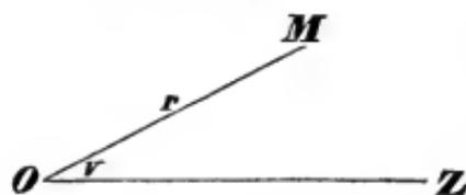
Die Lage eines Punktes  $M$  ist nun vollkommen bestimmt, wenn der Abstand dieses Punktes vom Pole, nämlich  $MO$ , und der Winkel  $MOZ$ , den diese Gerade mit der Polaraxe bildet, bekannt sind. Die Gerade  $MO$  heißt der Leitstrahl oder Ra-
