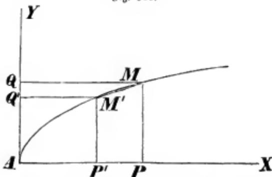
Es sei AM (Fig. 316) ein parabolischer Bogen und AX die Ase der Parabel; es soll die Fläche des Parabelstückes AMP gefunden werden.
