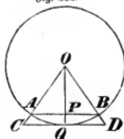
Es sei  $O$  (Fig. 262) der Mittelpunkt eines Kreises und  $AB = s$  die Seite des eingeschriebenen regelmäßigen  $n$ -Ecks. Zieht man  $OQ \perp AB$ , durch  $Q$  die Tangente  $CD$  und verlängert die Halbmesser  $OA$  und  $OB$ , bis sie jene Tangente in  $C$  und  $D$  schneiden, so ist  $CD = S$  die Seite des umschriebenen regelmäßigen  $n$ -Ecks.
