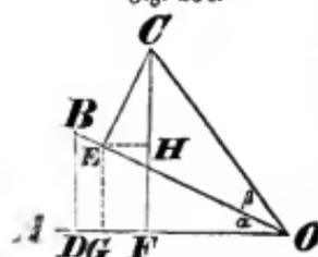
Ist (Fig. 254)  $AOB = \alpha$ ,  $BOC = \beta$ , so ist  $AOC = \alpha + \beta$ . Macht man nun  $OB = OC = 1$ , und zieht  $BD \perp AO$ ,  $CE \perp BO$ ,  $CF \perp AO$ , so ist
