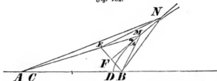
Man ziehe zu dem Punkte  $M$  die Leitstrahlen  $AM$  und  $BM$ , schneide  $ME = BM$  ab, verbinde  $E$  und  $B$  durch eine Gerade  $EB$  und halbire diese in  $F$ ; die durch  $F$  und  $M$  gezogene Gerade  $FM$  ist die verlangte Tangente.
