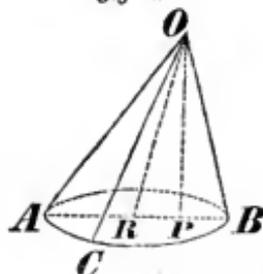
Der Kreis  $ABC$  (Fig. 224) ist die Grundfläche des Kegels; der Punkt  $O$ , in welchen die Mantelfläche ausläuft, heißt der Scheitel oder die Spitze, und die Gerade  $OR$ , welche den Scheitel mit dem Centrum der Grundfläche verbindet, die Ase des Kegels; die Senkrechte  $OP$  vom Scheitel auf die Grundfläche ist die Höhe. Wenn die Ase auf der Grundfläche senkrecht steht, heißt der Kegel ein gerader, sonst ein schiefer.
