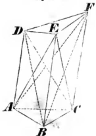
Es sei ABCDEF (Fig. 239) ein abgekürztes Prisma. Legt man durch die Punkte A, E, C eine Ebene, ferner durch C, E, D eine zweite Ebene, so zerfällt dasselbe in drei Pyramiden EABC, EACD und ECDF; es ist also  $ABCDEF = EABC + EACD + ECDF$
