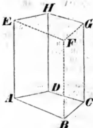
Die Oberfläche eines Prisma findet man, wenn man zuerst die Seitenflächen als Parallelogramme berechnet, durch deren Summierung die Seitenoberfläche erhalten wird, und noch die doppelte Grundfläche dazu addirt. Heißt  $O$  die Oberfläche,  $S$  die Seitenoberfläche und  $B$  die Basis, so ist  $O = S + 2B$ .
