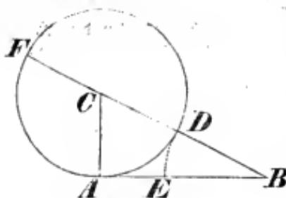
Man errichte in A eine Senkrechte auf AB, schneide davon  $AC = \frac{1}{2} AB$  ab, beschreibe aus C mit dem Halbmesser CA einen Kreis, und ziehe durch B und C eine Gerade, welche den Kreis in zwei Punkten D und F schneidet; macht man nun  $BE = BD$ , so ist die Gerade AB im Punkte E nach dem äußern und mittlern Verhältnisse getheilt.
