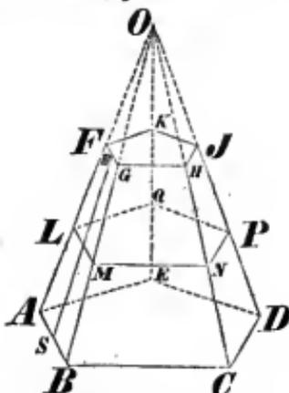
Entsteht der Pyramidalstuf durch den Schnitt einer regelmäßigen Pyramide, so sind die Seitenflächen kongruente Trapeze; man braucht daher, um  $S$  zu erhalten, nur den Flächeninhalt eines solchen Trapezes mit der Anzahl derselben zu multiplizieren.
