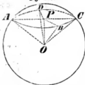
Es sei ABCD (Fig. 225) der Durchschnitt einer Ebene mit der Oberfläche der Kugel. Da die Punkte A, B, C, D, . . . in der Oberfläche der Kugel liegen, so sind die Geraden AO, BO, CO, DO, . . . als Halbmesser der Kugel gleich. Fällt man nun von O auf die Ebene ABCD die Senkrechte OP, so sind die rechtwinkligen Dreiecke APO, BPO, CPO, DPO, . . . kongruent, daher  $AP = BP = CP = DP = \dots$ ; es liegen also die Punkte A, B, C, D, . . . in dem Umfange eines
