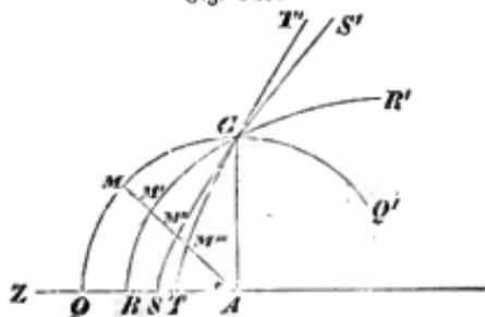
Stellt A (Fig. 319) den Pol, AZ die Polaraxe vor, so hat man, wenn p beim Kreise den Halbmesser, bei den übrigen Kurven den halben Parameter bedeutet, folgende Polargleichungen:
