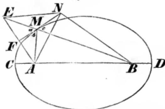
Man ziehe an den Punkt  $M$  die Leitstrahlen  $AM$  und  $BM$ , und verlängere  $BM$  bis  $E$ , so daß  $ME = AM$  ist. Sodann ziehe man die Gerade  $AE$  und halbire sie in  $F$ ; die durch  $F$  und  $M$  gezogene Gerade  $FM$  ist nun die verlangte Tangente.
