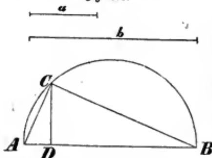
Für  $b > a$  kann auch die folgende Konstruktion sehr vorthailhaft angewendet werden. Man mache (Fig. 268)  $AB = b$ , beschreibe über  $AB$  als Durchmesser einen Halbkreis, trage aus  $A$  die Linie  $AC = a$  auf, und fälle von  $C$  auf  $AB$  die Senkrechte  $CD$ , so ist, wenn auch  $BC$  gezogen wird, in dem rechtwinkligen Dreiecke  $ACB$   $AB : AC = AC : AD$ , oder  $b : a = a : AD$ ,
