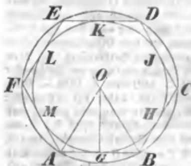
Es sei ABCDEF (Fig. 159) ein regelmäßiges Polygon. Halbirt man zwei Winkel, z. B. A und B, so besitzt der Durchschnittspunkt O der beiden Halbierungslinien die Eigenschaft, daß er von allen Seiten und eben so von allen Eckpunkten gleichweit absteht. Fällt man daher auf die Vielecksseiten von O aus Senkrechte, welche in den Punkten G, H, J, K, L, M eintreffen, und beschreibt aus O mit OG als Halbmesser einen Kreis, so muß die Peripherie desselben durch die Punkte
