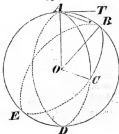
Zieht man die Halbmesser  $AO$ ,  $BO$ ,  $CO$ , so sind die Seiten  $AB$ ,  $AC$  und  $BC$  als Bögen von größten Kugelfreisen die Maße der entsprechenden Mittelpunktswinkel  $AOB$ ,  $AOC$  und  $BOC$ , deren Ebenen am Mittelpunkte  $O$  einen dreiseitigen körperlichen Winkel  $OABC$  bilden. Aus den Eigenschaften der Körperwinkel ergeben sich daher für ein sphärisches Dreieck, dessen Seiten einzeln nicht größer als  $180^\circ$  sind, folgende zwei Sätze:
