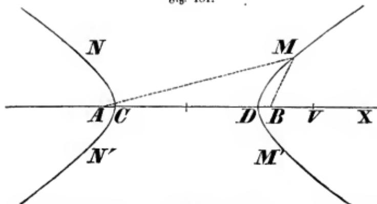
Es sei  $CD$  (Fig. 181) die erste Ase der Hyperbel,  $A$  und  $B$  seien die Brennpunkte. Man nehme in der Geraden  $BX$  irgend einen Punkt  $V$ , und beschreibe mit dem Halbmesser  $CV$  aus den beiden Brennpunkten nach oben und unten Bögen, hierauf eben so mit dem Halbmesser  $DV$ ; so werden die Durchschnittspunkte  $M, N, M', N'$  dieser Bögen in der Hyperbel liegen, denn es ist z. B. für den Punkt  $M$
