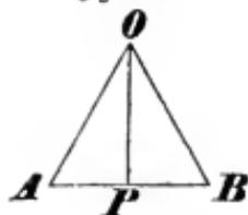
Es sei (Fig. 261)  $AB = s$  die Seite eines  $n$ -seitigen<sup>n</sup> regelmäßigen Polygons, dessen Mittelpunkt sich in  $O$  befindet und  $OP \perp AB$ . Offenbar ist dann der Winkel
