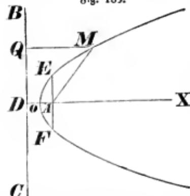
Ist  $A$  (Fig. 183) der gegebene Punkt und  $BC$  die gegebene Gerade, so liegt der Punkt  $M$  in der Parabel, wenn die Gerade  $AM$  der Senkrechten  $MQ$  gleich ist. Der gegebene Punkt  $A$  heißt der Brennpunkt, die Gerade  $BC$  die Richtungslinie der Parabel; die Gerade  $AM$  nennt man den Leitstrahl des Punktes  $M$ .
