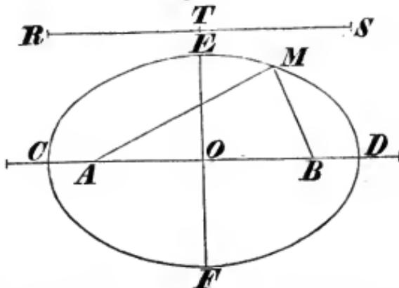
Sind A und B (Fig. 175) die zwei gegebenen Punkte, und RS die gegebene Gerade, so liegt der Punkt M in der Ellipse, wenn  $AM + BM = RS$  ist. Die zwei gegebenen Punkte A und B heißen die Brennpunkte; die Mitte O ihres Abstandes AB wird das Zentrum, und die Entfernung  $OA = OB$  die Exzentrizität der Ellipse genannt. Die Geraden AM und BM nennt man die Leitstrahlen oder Vektoren des Punktes M.
