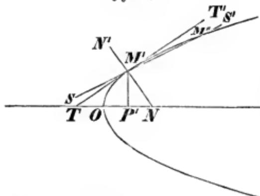
Heißen  $x'$ ,  $y'$  die Koordinaten des Punktes  $M'$  (Fig. 324) einer Parabel, deren Gleichung  $y^2 = 2px$  ist, so wird man, um die Gleichung der durch  $M'$  an die Parabel gezogenen Tangente zu erhalten, noch einen zweiten Punkt  $M''$  der Parabel nehmen, dessen Koordinaten  $x''$ ,  $y''$  seien. Die Gleichung der durch  $M'$
