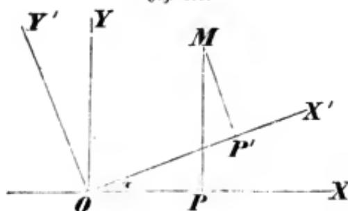
Bleiben die neuen Axen den alten parallel und wird nur der Anfangspunkt geändert, wie in Fig. 280, so ist  $\alpha=0$ , daher  $\sin \alpha=0$ ,  $\cos \alpha=1$ , und man hat zur Transformation die noch einfacheren Gleichungen
