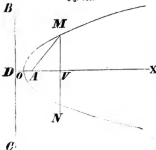
Es sei A (Fig. 185) der Brennpunkt und BC die Richtungslinie. Man ziehe von A auf BC eine Senkrechte AD und verlängere sie über A hinaus. Der Mittelpunkt O der AD ist der Scheitel der Parabel. Nimm man nun in der Ase OX irgend einen Punkt V, zieht dadurch die auf die Ase senkrechte Gerade MN, und beschreibet aus dem Brennpunkte A mit dem Halbmesser DV zwei Bögen, welche jene Senkrechte in den Punkten M und N durchschneiden, so müssen diese Punkte in der Parabel liegen, weil sie
