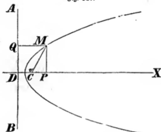
Es sei C (Fig. 317) der Pol und CD die Polare, so ist für den Punkt M  $r = CM$ ,  $v = MCD$ . Soll M ein Punkt der Parabel sein, so muß die Gleichung  $CM = MQ$  Statt finden. Nun ist
