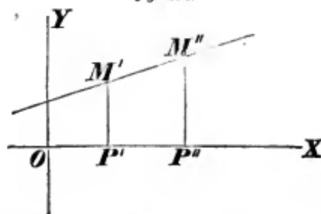
Es soll nun die Gleichung einer Geraden entwickelt werden, welche durch die beiden Punkte  $M'$  und  $M''$  geht, die man der Kürze halber auch die Punkte  $x'y'$  und  $x''y''$  zu nennen pflegt.
