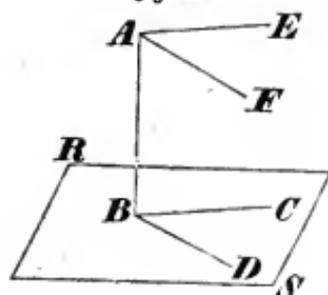
AE und AF, daher auch auf der durch den Winkel EAF gelegten Ebene senkrecht. Wenn aber AB auf der durch EAF gelegten Ebene und zugleich auf der Ebene RS senkrecht steht, so müssen diese Ebenen parallel sein.
