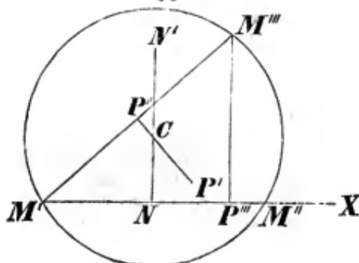
Es seien  $M', M'', M'''$  (Fig. 306) die drei Punkte, deren Koordinaten  $x', y', x'', y'', x''', y'''$  gegeben sind, und man suche die Gleichung des durch diese drei Punkte gelegten Kreises.
