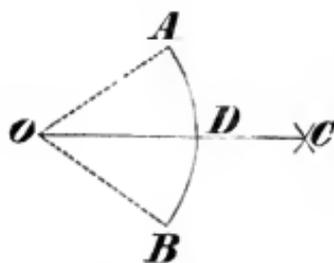
Man beschreibe aus den Endpunkten A und B mit demselben Halbmesser Bögen, welche sich in C schneiden, und ziehe die CO, welche den gegebenen Kreisbogen in D schneidet, so ist dieser Bogen im Punkte D halbirt.
