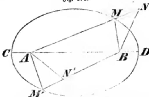
Es sei N (Fig. 176) ein Punkt außerhalb der Ellipse; verbindet man ihn mit den Brennpunkten A und B durch die Geraden AN und BN, deren erstere die Ellipse in M schneidet, und zieht die BM, so ist  $MN + BN > BM$ , folglich auch  $AM + MN + BN > AM + BM$  oder  $AN + BN > AM + BM$ ; allein da M ein Punkt der Ellipse ist, so ist  $AM + BM = CD$  daher muß  $AN + BN > CD$  sein.
