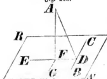
Man ziehe in der Ebene RS eine beliebige Gerade BC, falle in der durch A und BC gelegten Ebene von A auf BC die Senkrechte AD; in D errichte man in der Ebene RS auf BC die Senkrechte DE, und führe darauf in der durch den Winkel ADE gelegten Ebene von A aus die Senkrechte AF; so steht AF auch senkrecht auf der Ebene RS.
