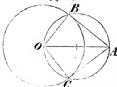
Man verbinde den gegebenen Punkt A mit dem Centrum durch eine Gerade AO, beschreibe über dieser als Durchmesser einen Kreis, welcher den gegebenen Kreis in den Punkten B und C schneidet, und ziehe die Geraden AB und AC, so sind diese Tangenten des gegebenen Kreises.
