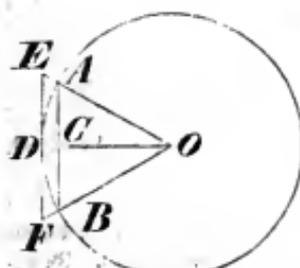
Es sei (Fig. 164)  $AB = s_n$  die Seite des einem Kreise eingeschriebenen nseitigen regelmäßigen Vielecks, und der Halbmesser dieses Kreises  $AO = r$ . Fällt man von O auf AB eine Senkrechte, welche die Peripherie in D trifft, und errichtet in D auf den Halbmesser OD eine Senkrechte, welche die verlängerten Halbmesser OA und OB in den Punkten E und F schneidet, so ist EF die Seite des umschriebenen nseitigen regulären Polygons.
