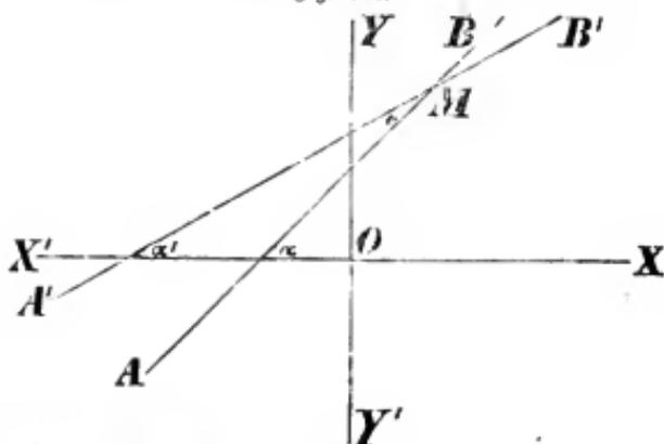
Für alle Punkte der Geraden AB ist  $y = ax + b$ , für alle Punkte der Geraden A'B' ist  $y = a'x + b'$ ; für den Punkt, der in den beiden Geraden liegt, nämlich für den Durchschnittspunkt M, muß daher  $y = ax + b$  und zugleich auch  $y = a'x + b'$  sein. Dem Punkte M werden also jene Koordinaten  $x$  und  $y$  zukommen, durch welche beiden Gleichungen zugleich Genüge geleistet wird; diese Werthe erhält man offenbar durch Auflösung jener zwei Gleichungen, man bekommt nämlich
