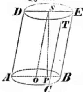
Der Zylinder ist ein Körper, welcher von zwei gleichen und parallelen Kreisflächen und einer solchen gekrümmten Fläche, die von jeder durch die Mittelpunkte jener Kreise gelegten Ebene in geraden Linien geschnitten wird, begrenzt ist.
