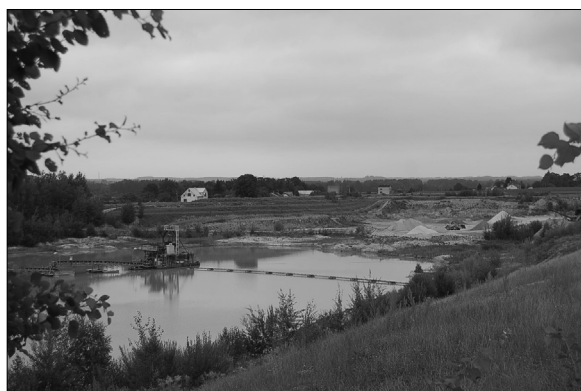
Obr. 27b: Pískovna v Dolní Lutyni na Karvinsku – mokrá způsob těžby (foto: I. Smolová).
