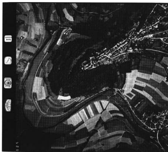
Obr. 3.8 Letecký měřický snímek s rámovými údaji (vlevo)
