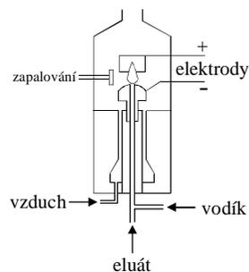
c) detektor elektronového záchytu, ECD
