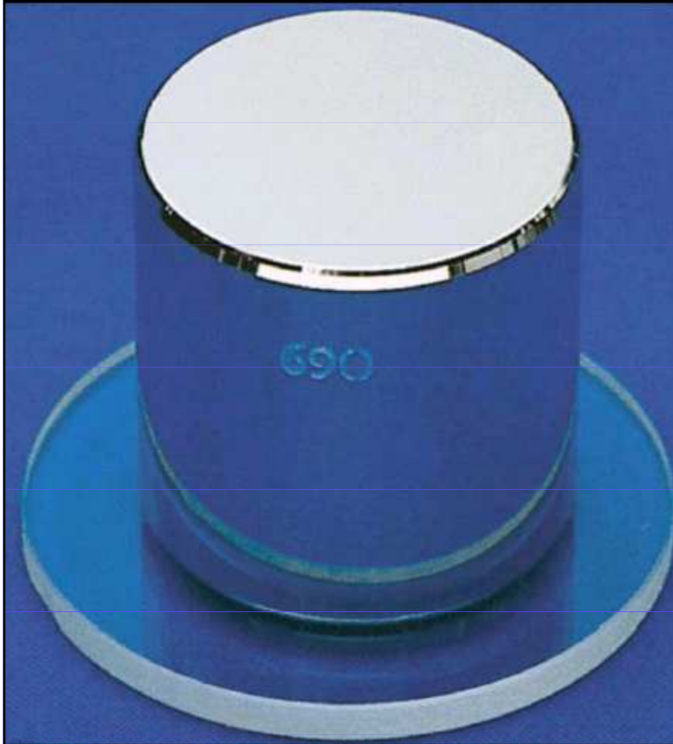
Obr. 1.6 Mezinárodní hmotnostní standard 1 kg má tvar válce, jehož výška i průměr jsou 39 mm.
