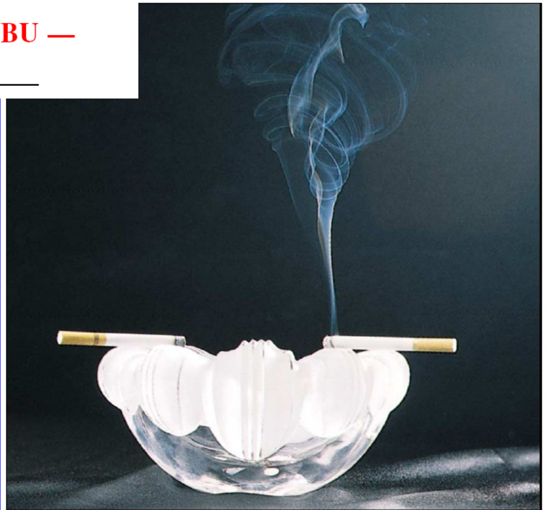
Obr. 15.12 V určitém bodě změní stoupající proud kouře a ohřátého vzduchu charakter proudění z laminárního na turbulentní.
