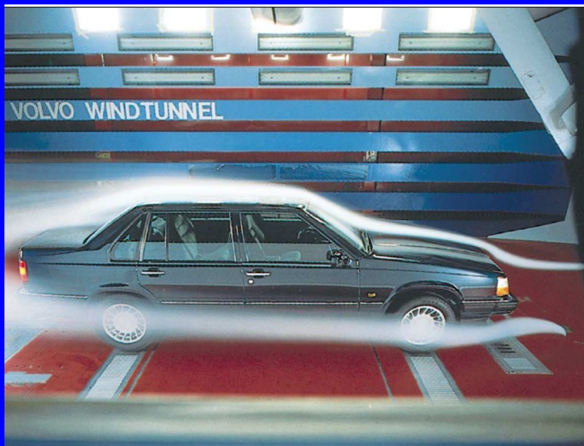
Obr. 15.14 Kouřem zviditelněné proudnice, které obtékají automobil umístěný v aerodynamickém tunelu.
