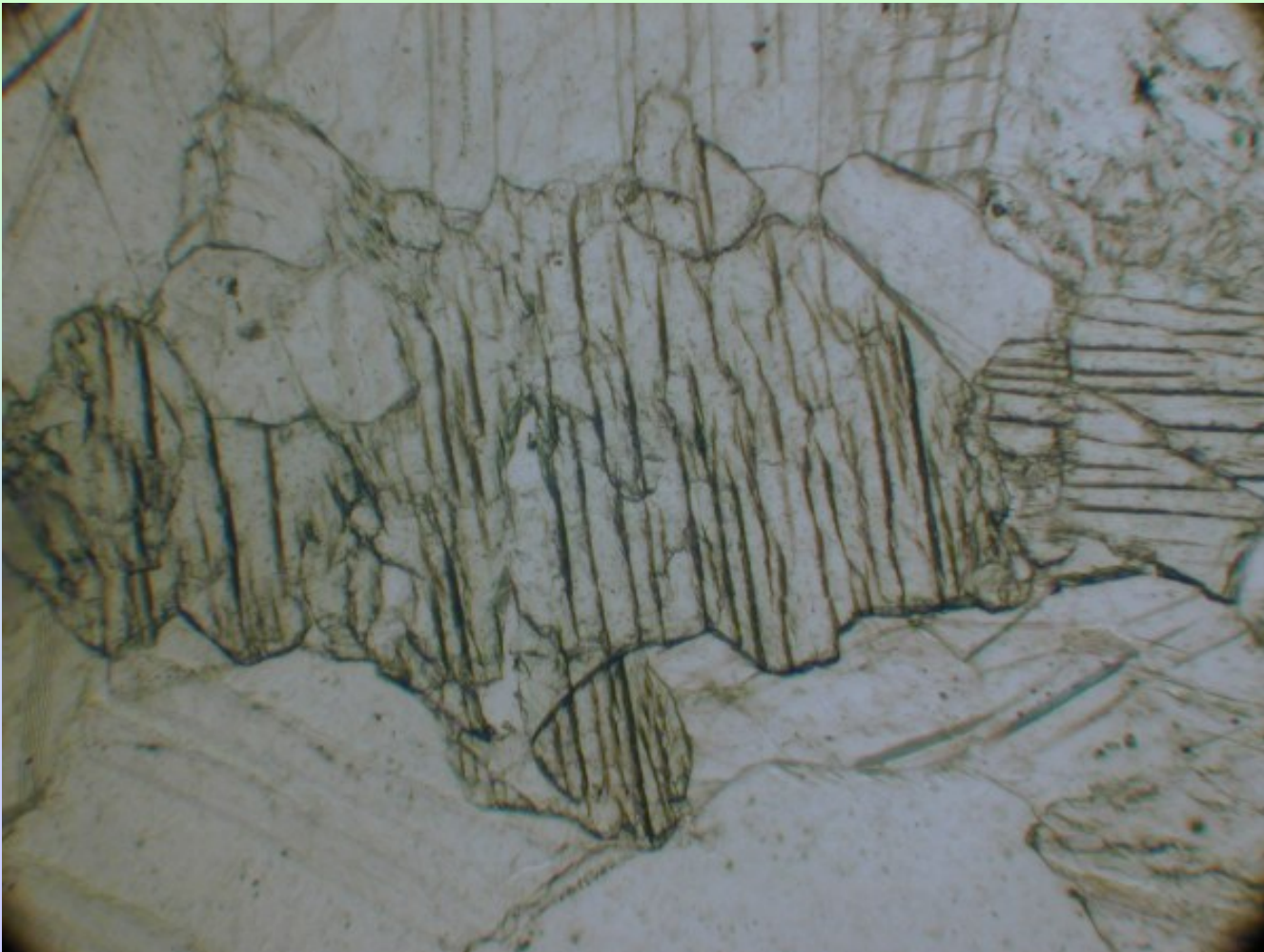
monoklinický pyroxen s viditelným jedním systémem štěpnosti, obklopen karbonátem; PPL
