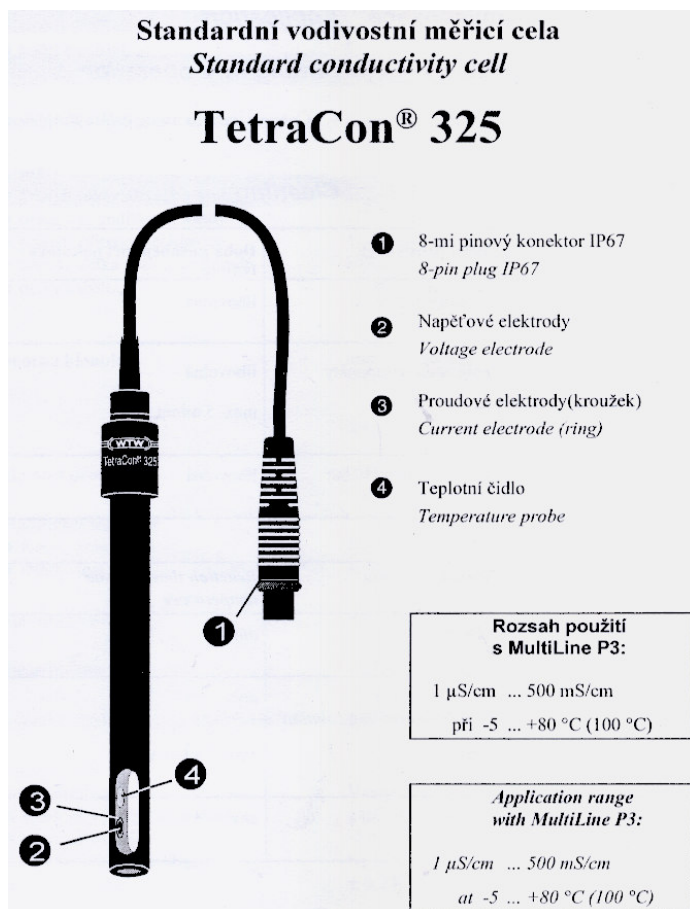
Obr. 15 Popis těla sondy sloužící k měření konduktivity
