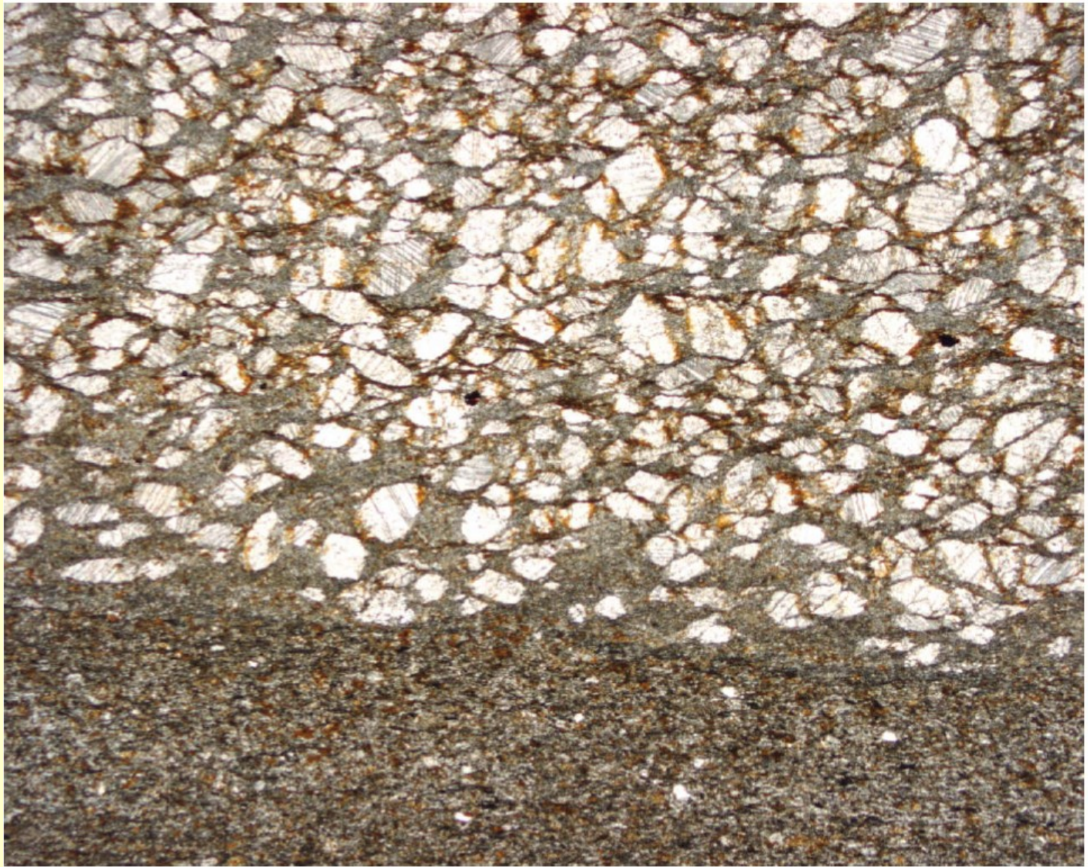
metapelit na kontaktu s metaslínovcem (Qtz+Ms+Chl+Cal+Limonit, Grafit)
