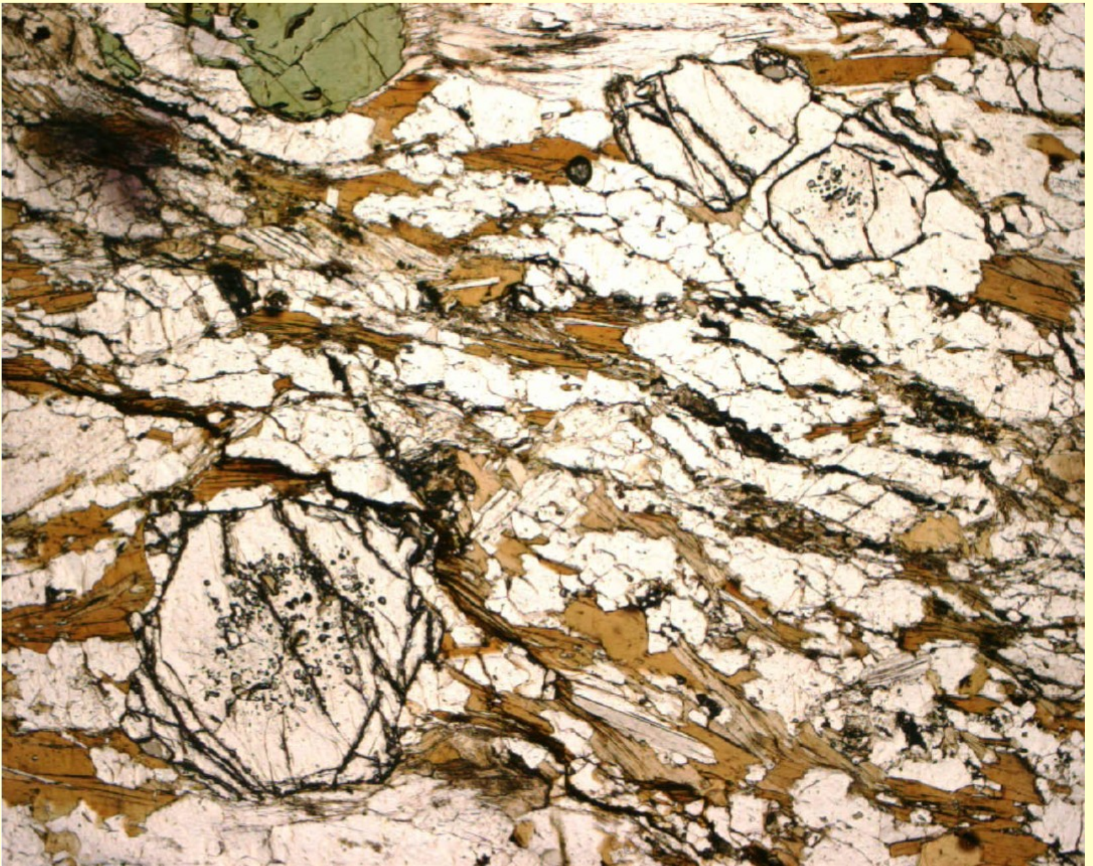
Granátická rula se sillimanitem: Qtz+Ms+Bt+Grt+Sil+Pl+Tu
