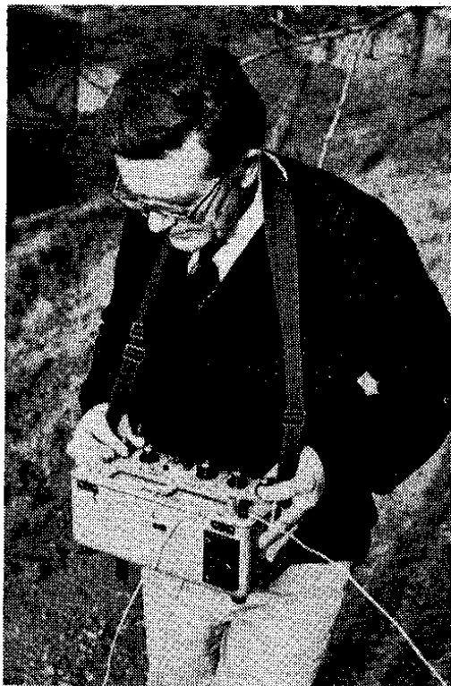
Obr. 36. Terénní měření metodou VP frekvenční aparatury firmy Scintrex (foto R. Duda)
