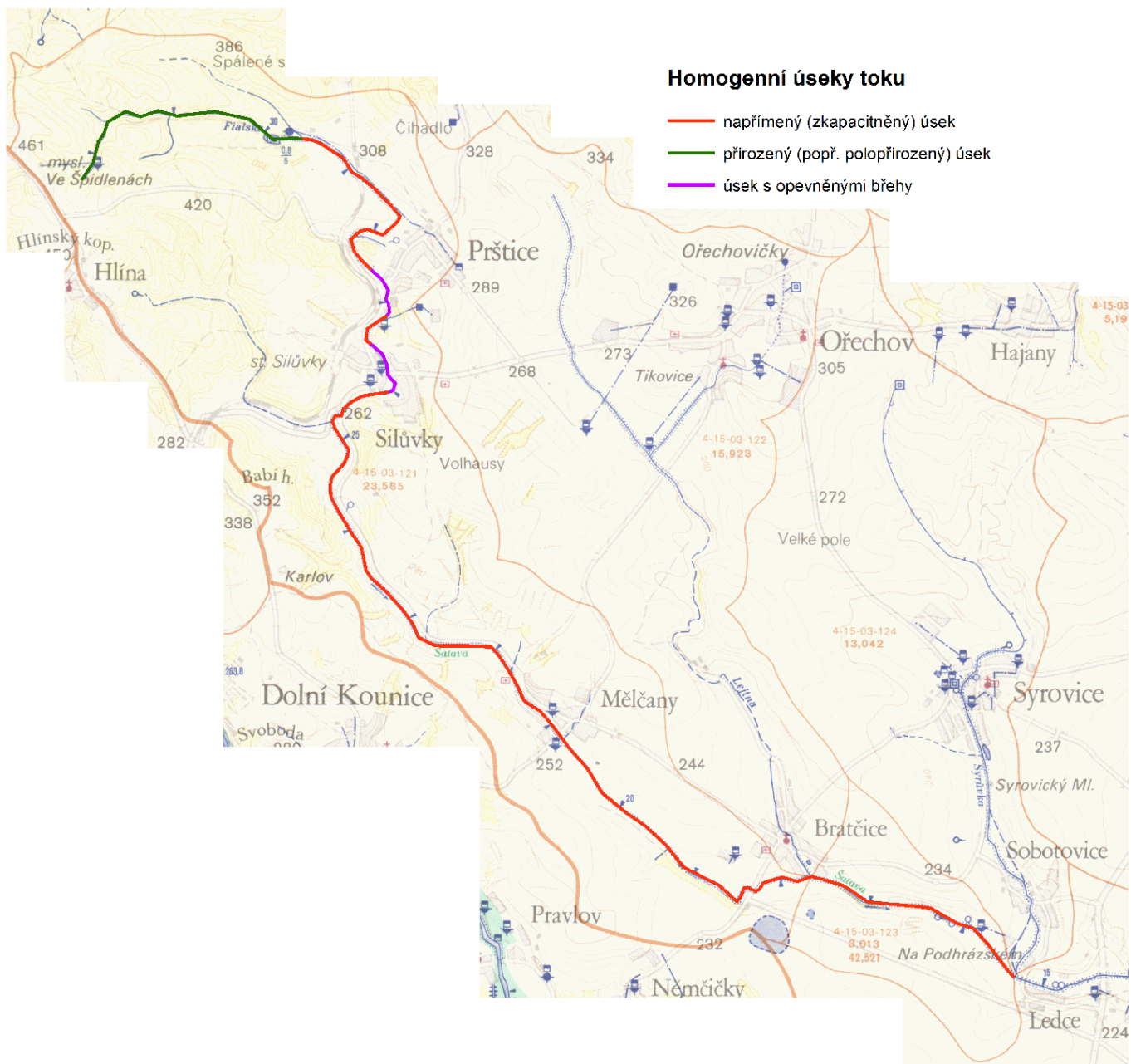
Obr. 30: Finální vymezení homogenních úseků úseků páteřního toku Šatavy
