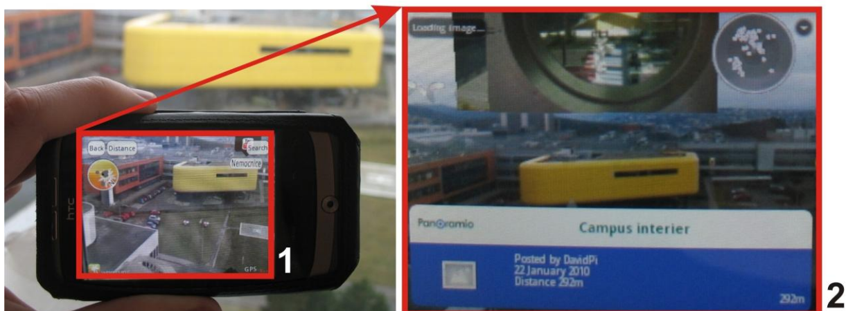
Obr. 6: Ukázka fungování augmented reality v mobilním telefonu s využitím aplikace Wikitude. Vlevo snímáný objekt integrovanou kamerou, vpravo vyvolané informace o snímaném objektu. Zdroj: J. Trojan, úprava J. Trávníček
