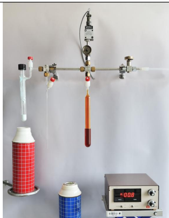
9-2 Rozvod inertní plyn/vakuum pro techniku Schlenkových nádobek.
