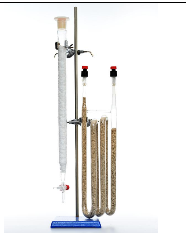
5-18 Sušící aparatura s KOH (vlevo) a molekulovým sítím (vpravo)
