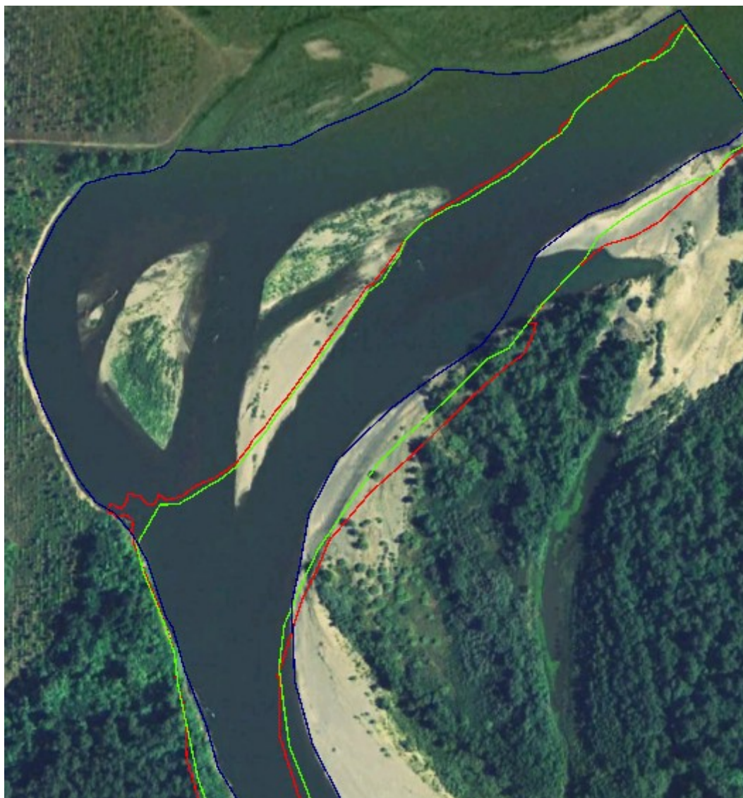
Obr. 4: Úsek 1. kilometru, kde proběhla největší eroze a akumulace za období 2005-2012
