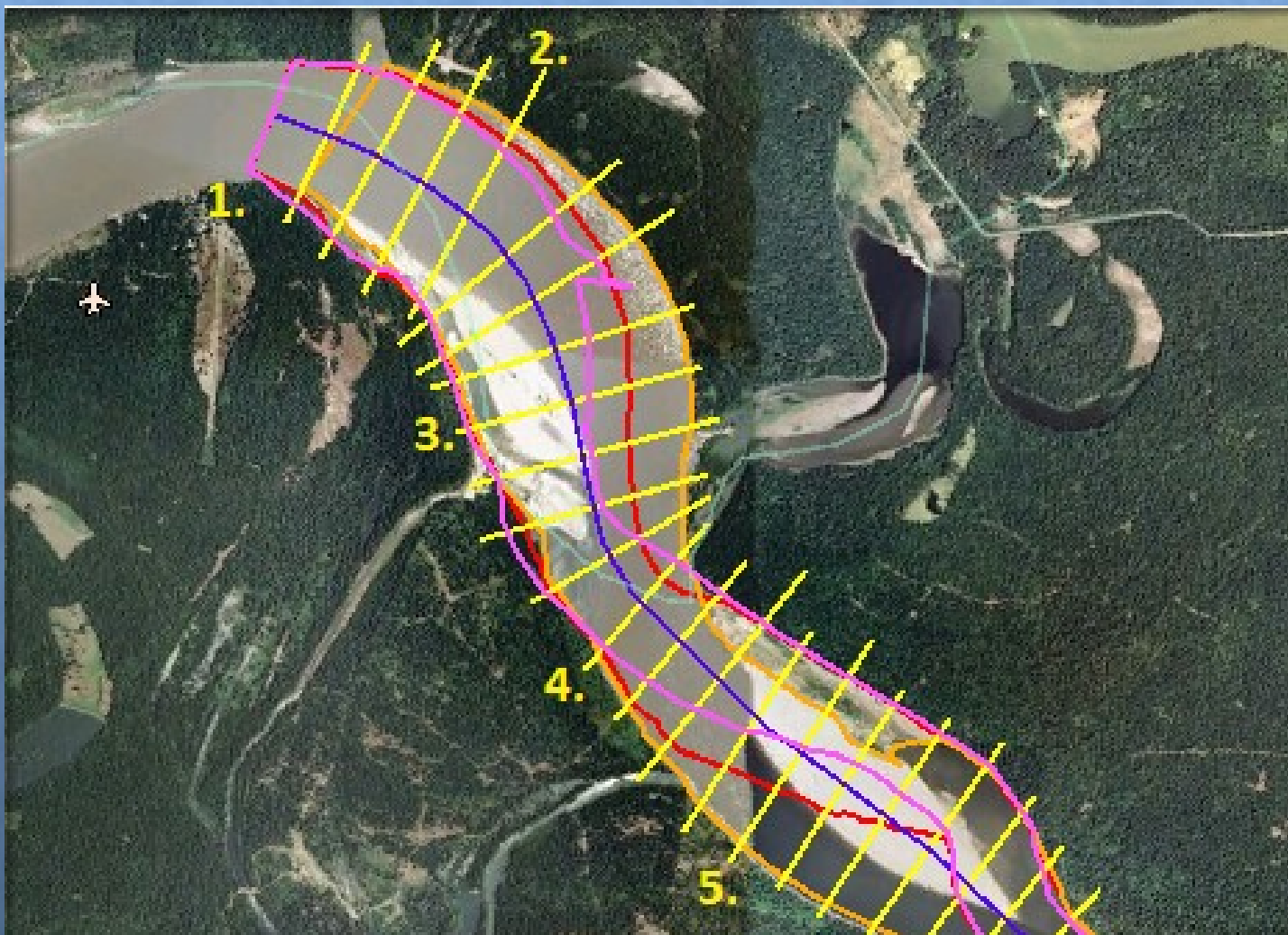
Obr. 4: Obrisy koryt řeky Arkansas v letech 1996, 2002 i 2010 (na podkladu snímku z roku 2010) a vyznačené 250 metrové úseky měření dle osy bufferu s přiloženou legendou (Google Earth).
