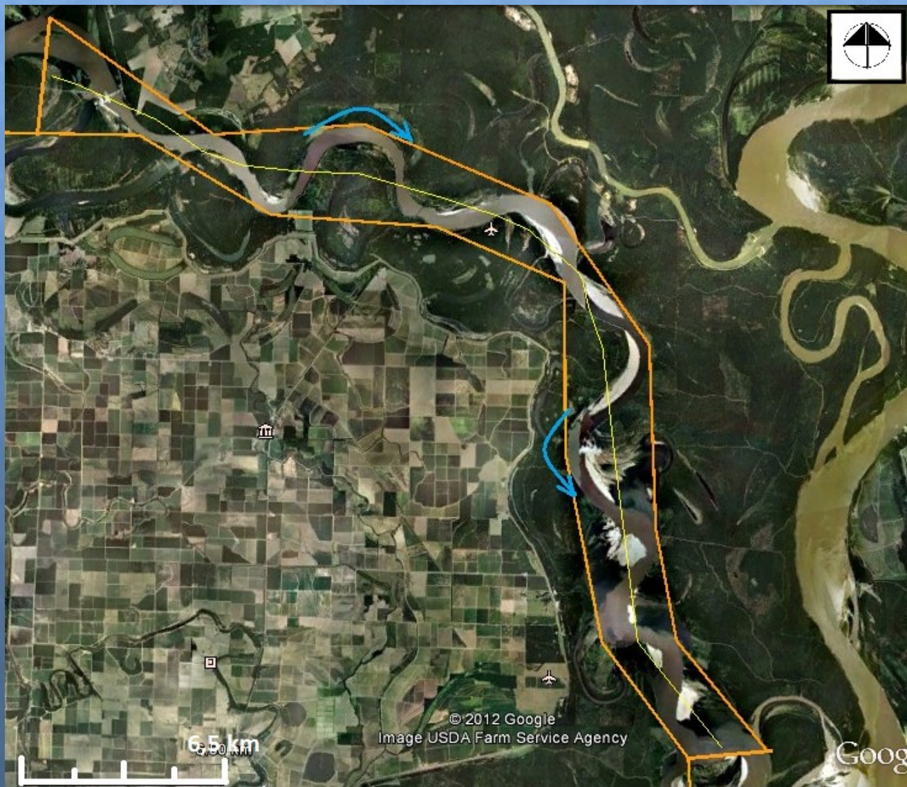
Obr. 1: mapa vybraného úseku řeky Arkansas v roce 2012 včetně vyznačení meandrového pásu, údolnice a směru toku (Google Earth).
