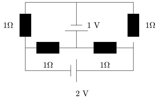
**Návod:** Součet všech proudů přitékajících do uzlu je roven součtu všech proudů z uzlu vytékajících, napětí zdroje v uzavřené smyčce je rovnou součtu úbytků napětí na odporech v této smyčce. Úbytek napětí na odporu se vypočte jako součin protékajícího proudu a odporu. Označte si, jako neznámé, proudy v jednotlivých větvích sítě a aplikací těchto zákonů získáte soustavu lineárních rovnic.
