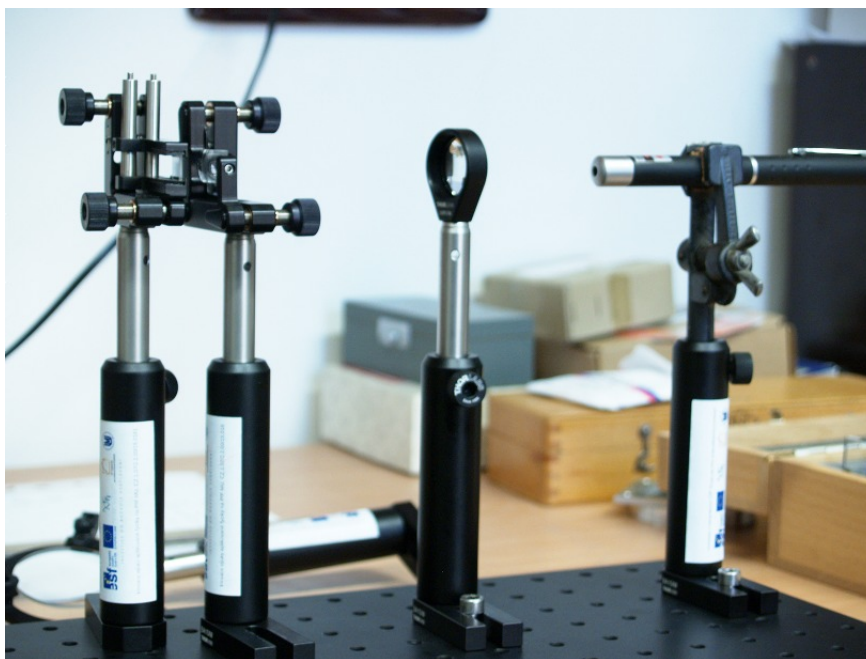
Obrázek 3: Konstrukce optické cesty na optické lavici.
