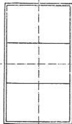
Obr. 107. Indukční clona v obdélníkovém vlnovodu.
