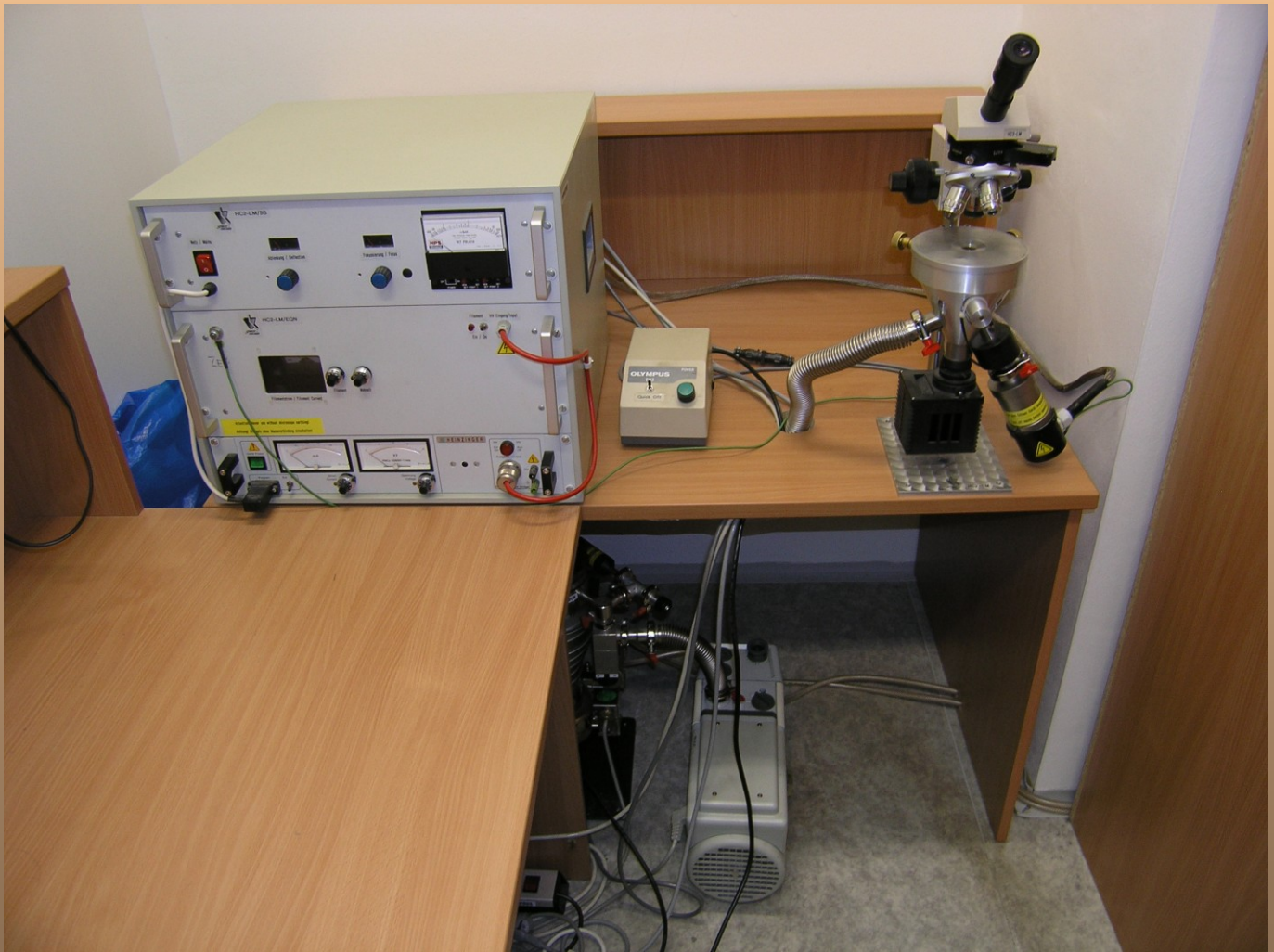
CL mikroskop s horkou katodou
