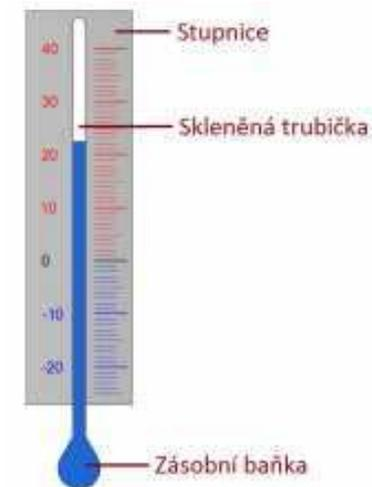
Nakreslete schematicky dva kapalinové teploměry
