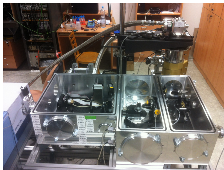
elipsometr do vzdálené IČ
