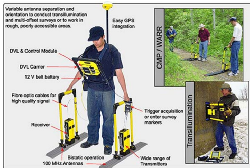
pulseEKKO PRO (Sensors & Software) 100 MHz antény o délce 1 m
