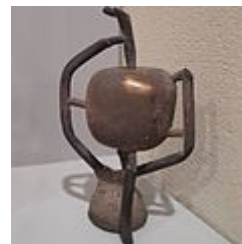
Kovový odlitek před začištěním dělicí roviny a stop po vtcích
