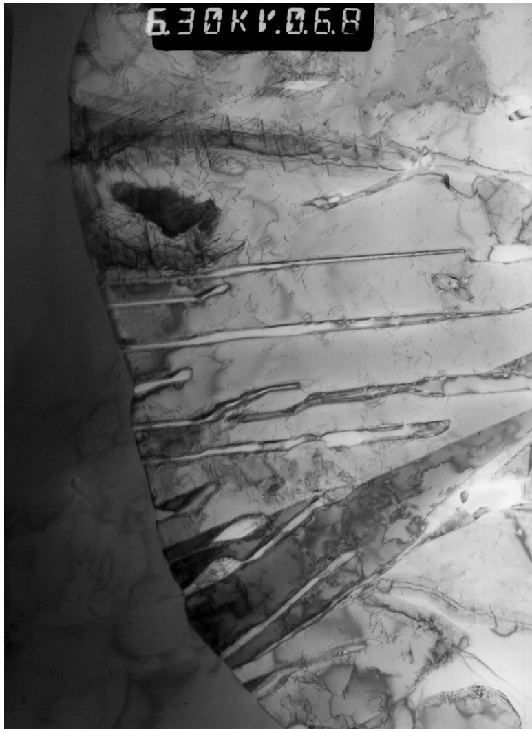
Materiál: 33Cr-31Ni-1,5Mo-Fe (NICROFER). Fázová mikrostruktura: sigma + b.c.c. Art: „Rytířská helmice“ popř. „Dotek motýlího křídla“.
