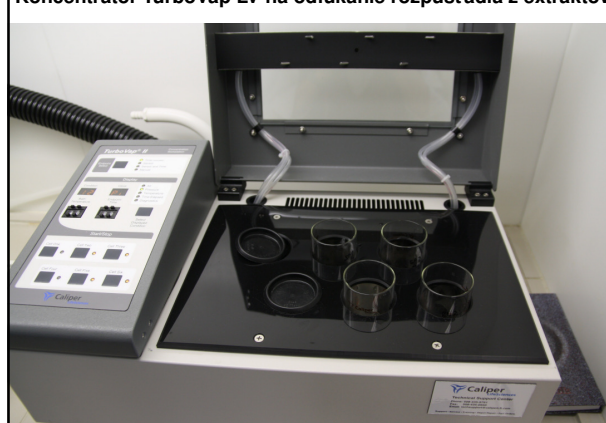
Konzentrátor TurboVap LV na odčúvanie rozpúšťadla z extraktov
