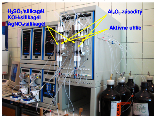
Automatizovaný systém spracovania vzoriek Power-Prep™ (konfigurácia pre 2 vzorky)
