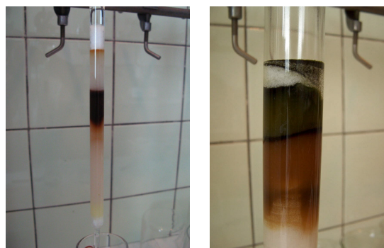
H 2 SO 4 /silikagelová kolóna používaná na počiatočné čistenie extraktov
