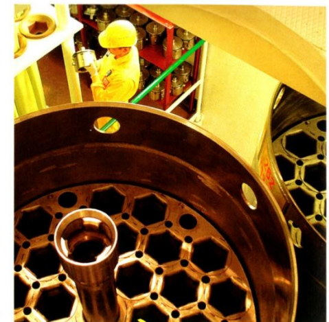
▣ Transportní zásobník paliva ve skladu čerstvého paliva
