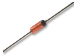
Obr. 11: Príklad signálovej diódy
