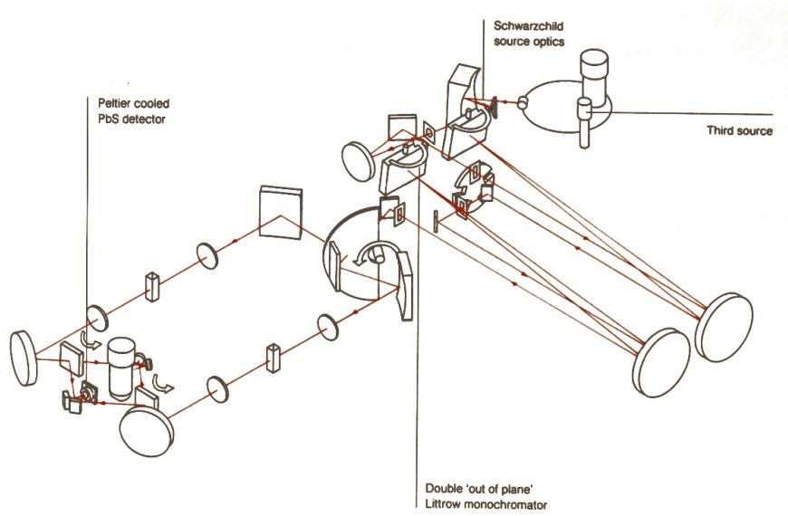
Obrázek 2: Schéma dvoukanálového spektrometru Varian Cary 5E
