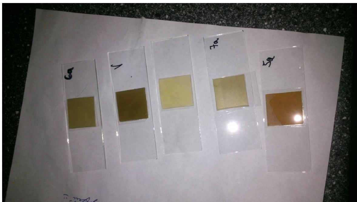
Obrázek č. 6 Filtry potahované nanočásticemi stříbra
