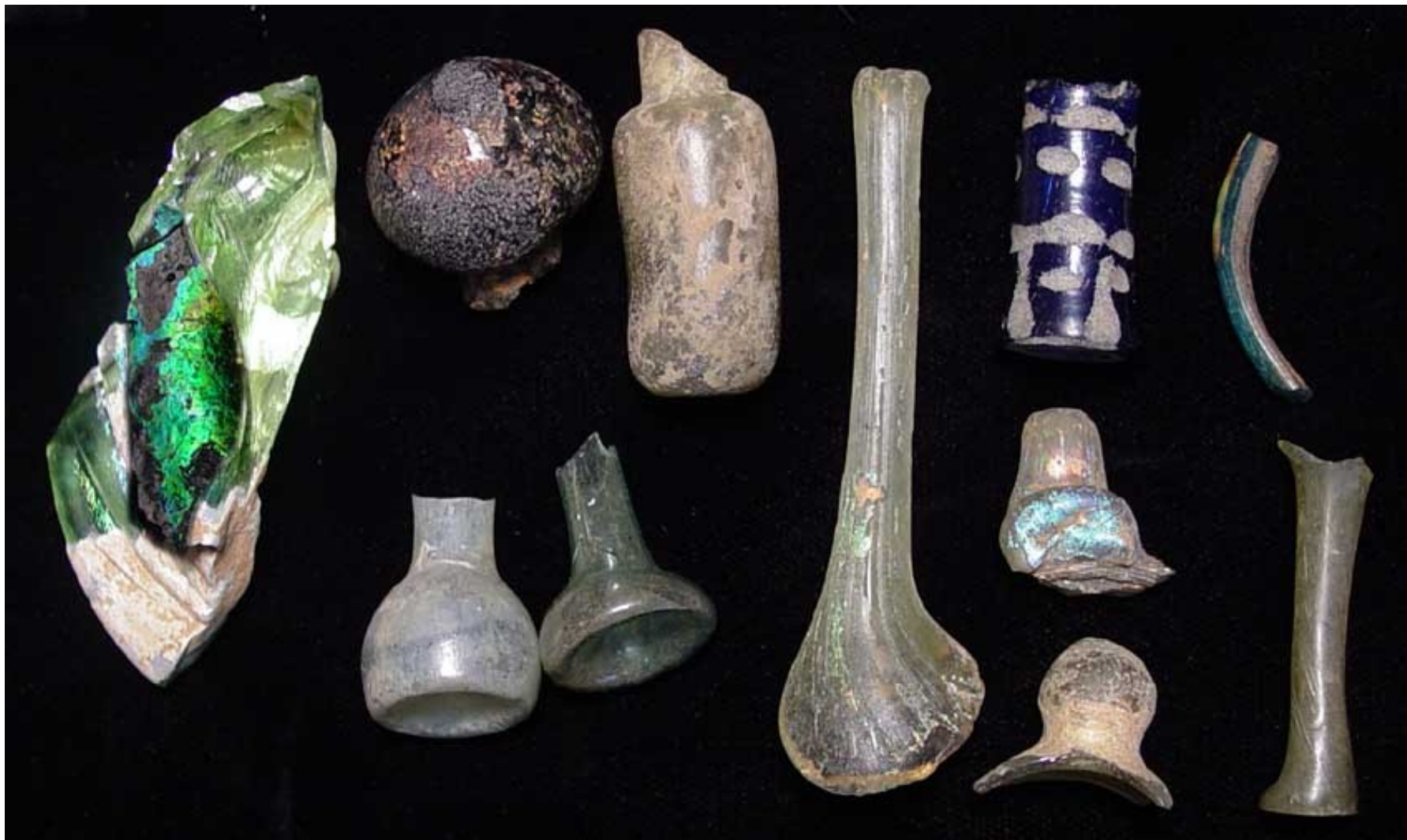
Úlomky starých skel s korozní iridiscenční vrstvou
