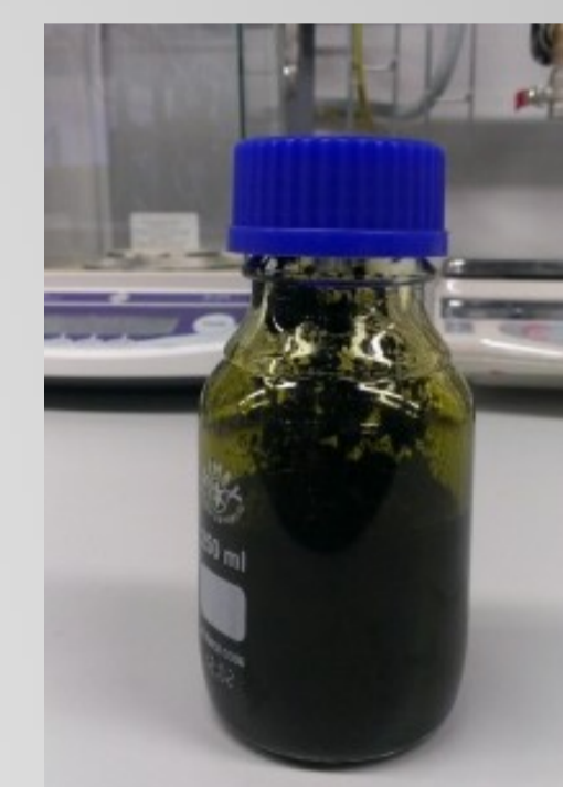
Vzhled reálného řasového oleje (extrakce hexanem/etanolom ze suspenze po flokulaci s KOH)
