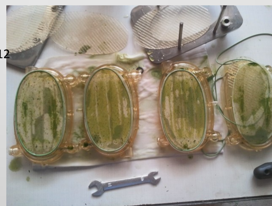
Nabohacení: Třeboň 2,8 krát (koncentrace v retenátu 69,2 g/l), ÚCHP 5,6 krát, (koncentrace řas v retenátu 12 g/l). Membrány se zanášejí a je je nutné čistit každou cca 3 hodinu práce.
