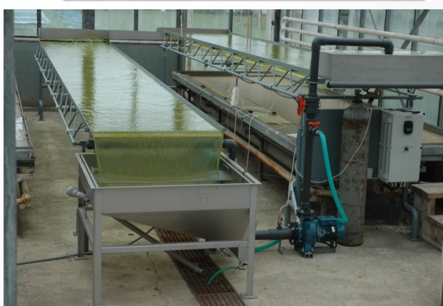
Experimenty flokulace řasy Chlorella vg. za aplikace chitosanu a amoniaku jako koagulantů
