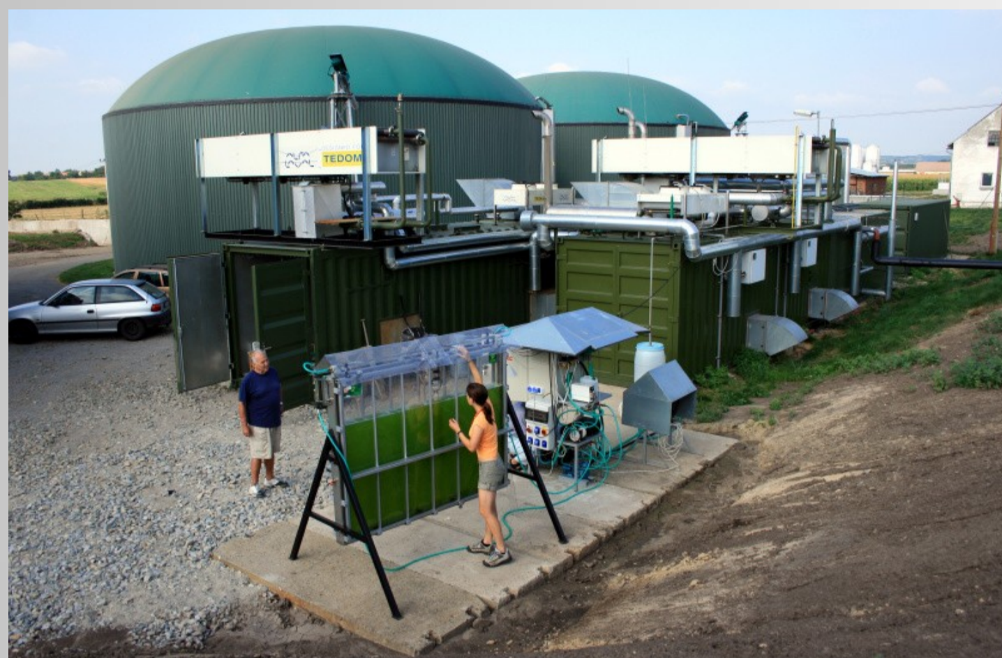
Vertikální uzavřený hranolový fotobioreaktor ÚCHP AV ČR integrovaný s bioplynovou stanicí, objem 300 l suspenze, tloušťka prosvětlované vrstvy 50 -110 mm
