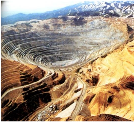
Jámový důl na měď Bingham v Utahu (4 km průměr, 800 m hloubka).
