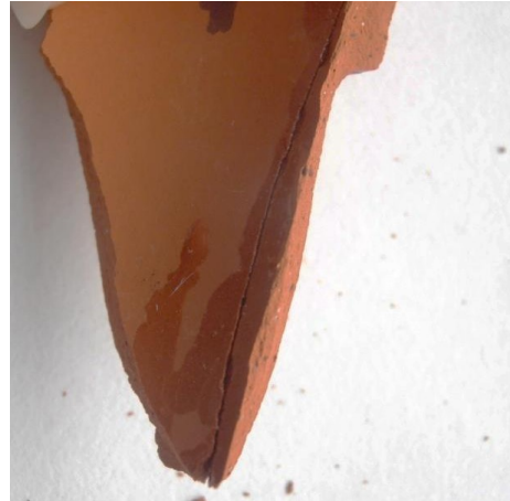
Obr. 7 Lepený spoj s vyšší odolností
