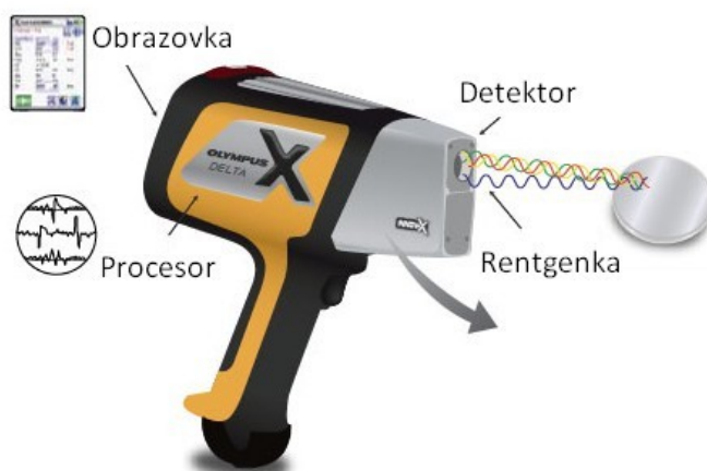
Obr. 2 Schematické znázornění ručního XRF spektrometru [2]
