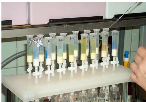
Izolácia PCB a ďalších POPs z krvného séra na tuhej fáze (C 18 -SPE)
