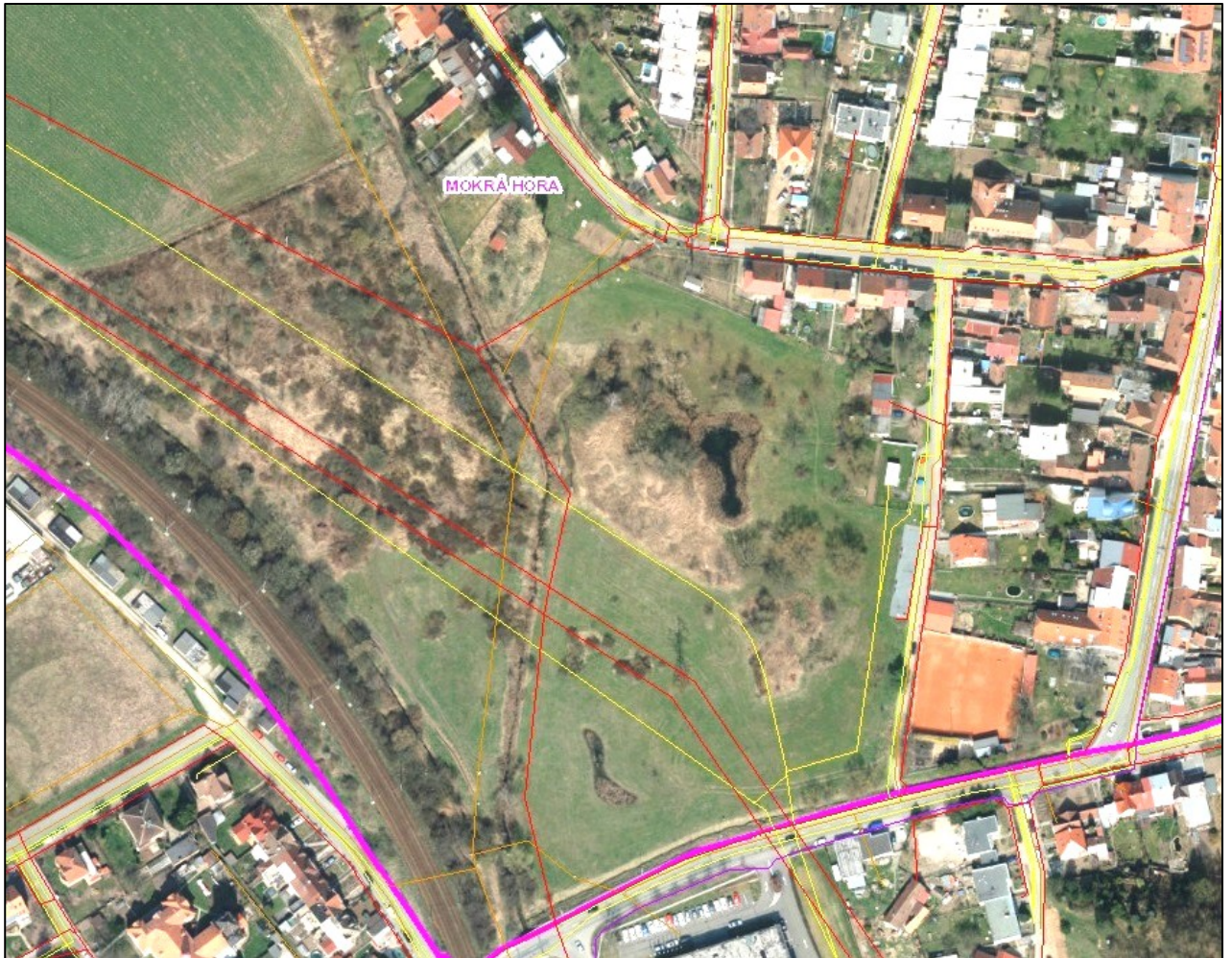
Obr. č. 3. Zákres inženýrských sítí v ploše biocentra, dle údajů z GIS Magistrátu města Brna. Červeně jsou vyznačeny elektrovody, žlutě plynovody a světle hnědě kanalizace. Elektrické nadzemní vedení východní strany koryta Ponávky od rákosiny k jihu již neexistuje.
