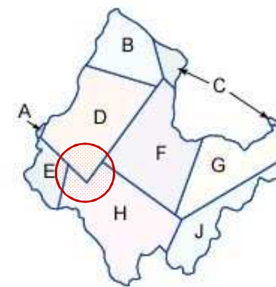
4) K ploše výsledného polygonu se vztahuje odpovídající úhrn srážek dané meteorologické stanice
